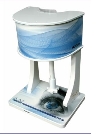
Le CV-2100 comprend un système innovant de présentation par LEDs qui permet de tester le champ visuel temporal et nasal, à l'horizontal et aux angles de +30° et −30°. Sa conception originale a fait l'objet d'un dépôt de brevet en 2013.
